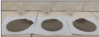
Figura 13: Resultados de ensayos de filtración a vacío – M – 1
