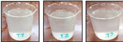
Figura 7: Turbidez del overflow en la descarga de Muestra M-2
